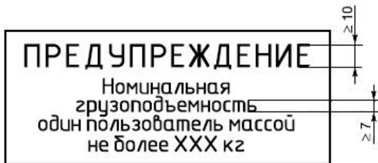
Рисунок 6 - Образец стандартной надписи с информацией о грузоподъемности
