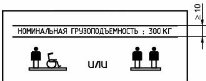
Рисунок 8 - Пример таблички с информацией о грузоподъемности
